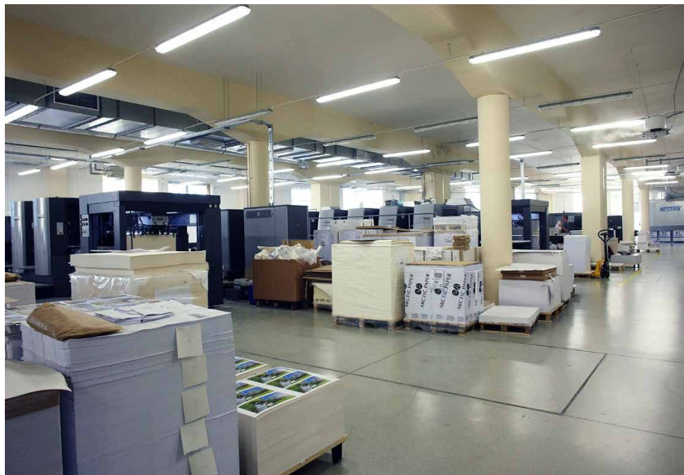
Ryc. 37. Drukarnia Skleniarz w Krakowie – fragment strefy produkcyjnej. Szczupłość terenu zakładu wymusiła jego zblokowanie i spiętrzenie do trzech kondygnacji, co skutkuje relatywnie gęstym układem słupów nośnych i rozbudowaną konstrukcją stropów.
