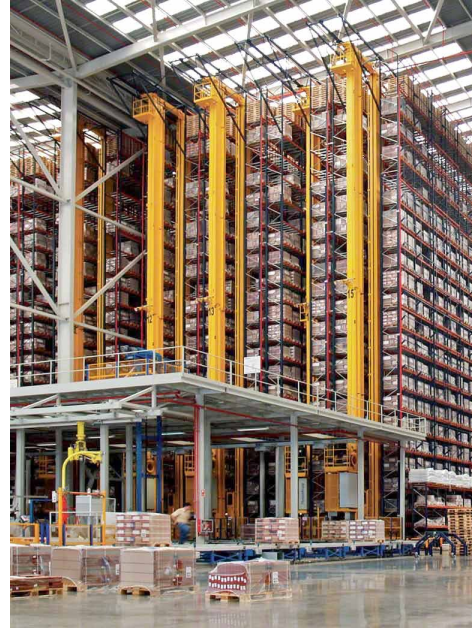
Ryc. 51. Przykład zautomatyzowanego magazynu regalowego wysokiego składowania z wykorzystaniem manipulatorów.
