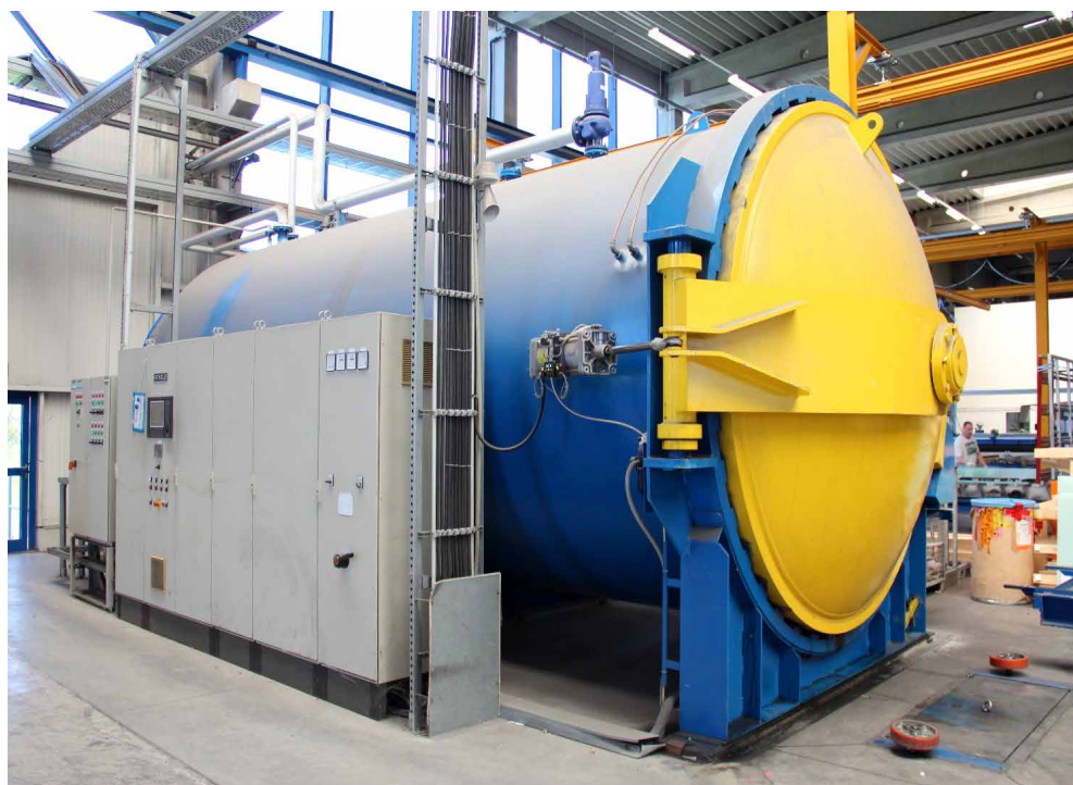
Ryc. 75. Przykład ustawienia ciężkiego elementu wyposażenia technologicznego (autoklawu ciśnieniowego) na masywnej płycie podłogowej w zakładzie obróbki szkła budowlanego Scholl Glas w Nossen w Saksonii (Niemcy).
