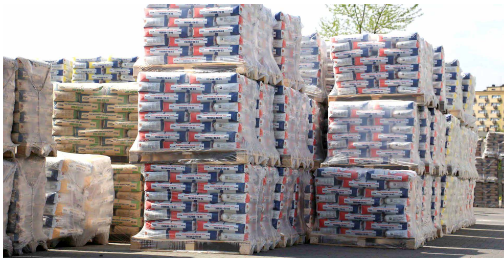
Ryc. 47. Przykład składowania jednostek ładunkowych w stosach, w przestrzeni zewnętrznej zakładu. Takie postępowanie wymaga oczywiście zabezpieczenia materiałów przed wpływem czynników atmosferycznych i jest z reguły składowaniem krótkoterminowym.
